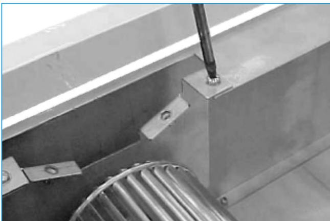
Retire el soporte que fija la turbina.
