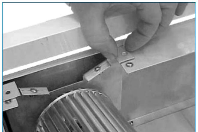
Desplace el soporte de la turbina hacia el exterior de la turbina.
