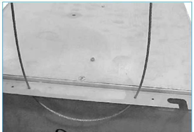
Ejemplo de fijación de la cortina mediante cable.
